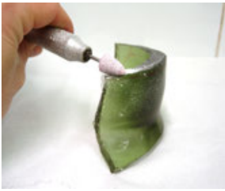
Ajust de la forma de cada placa, rebaixant la resina amb Microtorn amb broca de pedra rosa, bisturí i paper de vidre de diferents granulometries. (©M.Golobardes-MUHBA)
