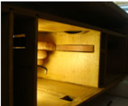
Aquestes pinces són la clau del mecanisme, per un costat traven els calaixos i per l'altre els alliberen. Per obrir-los cal fer un moviment de separació cap a la dreta en l'extrem corb de la pinça, moviment que
