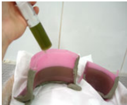
Preparació dels motlles de cera de dentista o de Reus seguint la forma del vas i colat de la resina en els motlles per a obtenir les diferents plaques. (©M.Golobardes-MUHBA)
