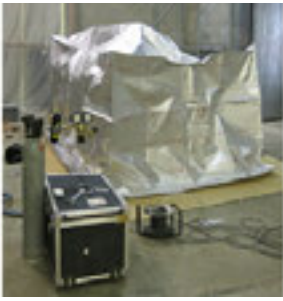
La desinsectació de les peces de la col·lecció es realitza per anòxia substituint l'oxigen per un gas inert.
