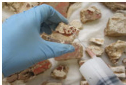
Consolidació de motllures amb Nanorestore®, nanopartícules de calç disperses en alcohol. (©Àbac-MUHBA)
