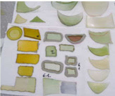
Preparació del color de la reintegració amb resina epoxídica Araldite 2020® i pigments microlítics (gra molt fi): Microlith Blau GS-T, Microlith Groc 3R-T, Microlith Orasol Groc 2GLN i Microlith ocre. (©M.Golobardes-MUHBA)
