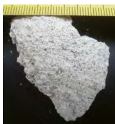
Figura 91. Mostra de morter extreta dels paraments romans de la torre D/III/6 (torre 76 segons la numeració tradicional).
