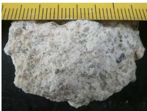
Figura 79. Mostra del morter de l' opus caementicium del tram de cortina entre les torres D/III/4 i D/III/5 (torres 74 i 75 segons la numeració tradicional). Superfície interna de la mostra.
